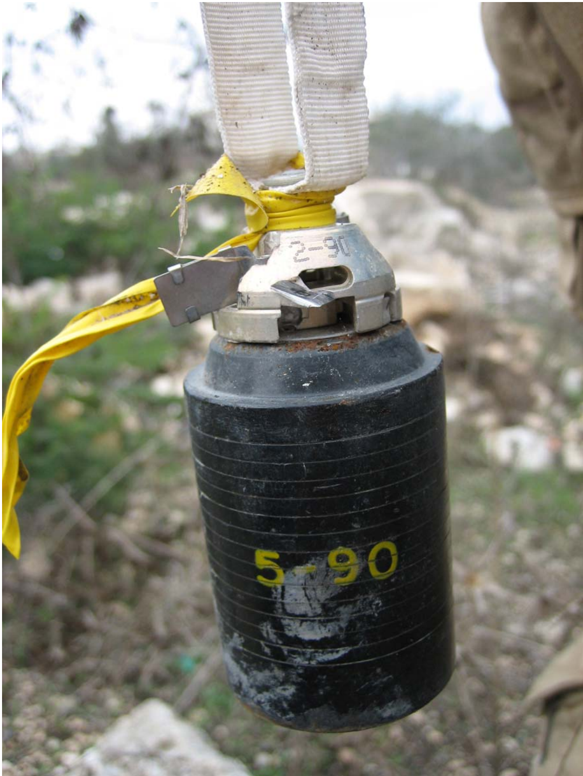
איש צוות פינוי תחמושת אוחד בתחמושת-משנה מסוג M85 מתוצרת ישראל שנטרל בבית יאהון ב-24 באוקטובר 2006. לחלק מפצצות-המשנה מסוג זה היה מנגנון להשמדה עצמית, אך אנשי מקצוע מתחום פינוי התחמושת ומומחי לנשק תיעדו בשטח שיעור נפלים של 10% אפילו לדגמים אלה. © 2006 בוני דוקרטי / Human Rights Watch
