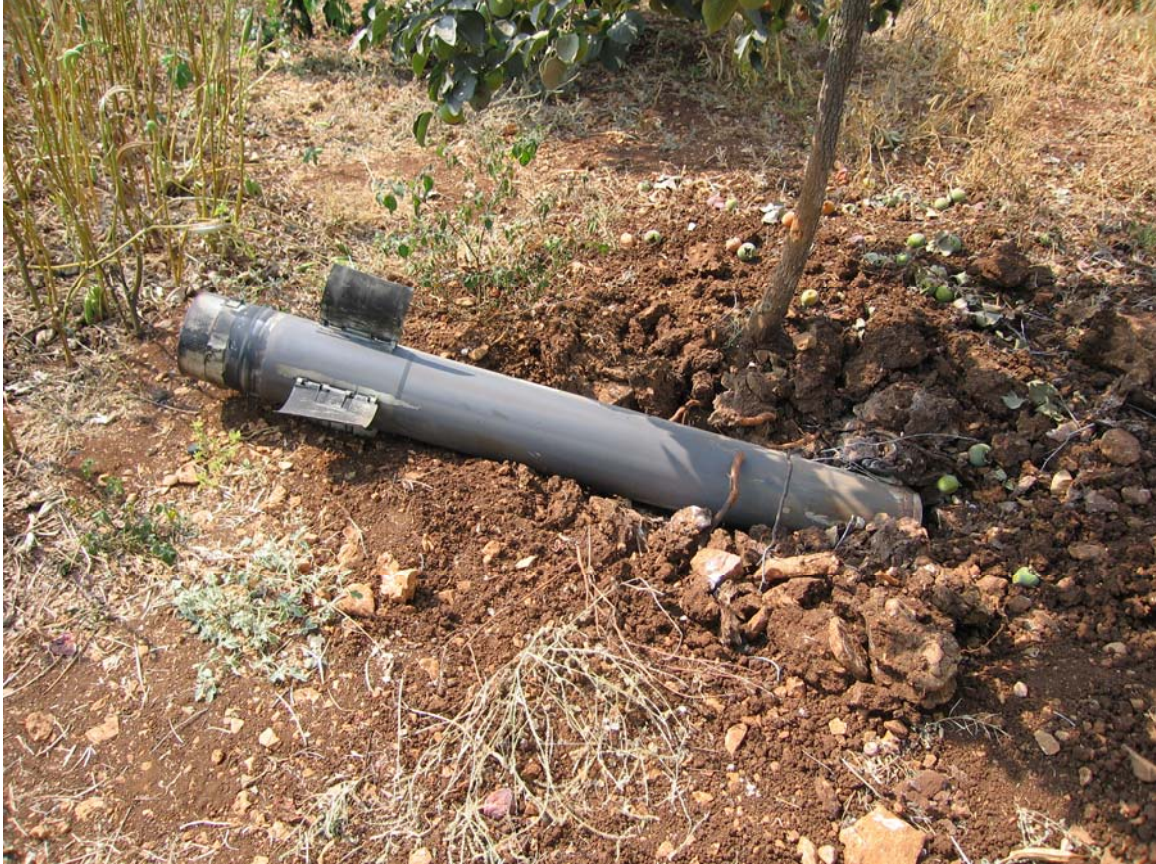
מנוע רקטי מסוג M26 מתוצרת ארה"ב, שנורה במערכת שיגור רקטות רב-קנית (MLRS) נחת בתבנין, ונראה כאן ב-16 באוגוסט 2006. במהלך המלחמה ירתה ישראל לשטח לבנון מאות רקטות כאלה, הנושאות כל אחת 664 פצצות-משנה מסוג DPICM. © מארק גרלאסקו / Human Rights Watch
