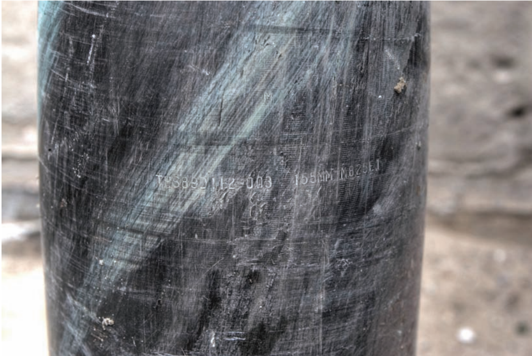
قذيفة مدفعية فيها فسفور أبيض عليها الطلاء الأخضر الكاشف عن الحقيقة، إنه الطلاء المستخدم لتلوين هذه القذائف. تمت صناعة هذه القذيفة في شركة "ثيو كول إيروسبايس" الأمريكية في أبريل/نيسان 1989. والختم الموجود على القذيفة طراز M825E1 هو كود الجيش الأميركي لقذائف الفسفور الأبيض التي تحتوي على 12.74 رطلاً من الفسفور، وهي تحترق على درجة حرارة 1500 درجة فهرنهايت حين تتعرض للأوكسجين. © 2009 مارك غارلاسكو/هيومن رايتس ووتش
